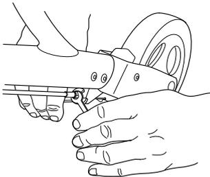
1. Si l'effet de freinage est faible, réglez le câble de frein. L'outillage adéquat à utiliser comprend des clés fixes, de 7 mm pour le réglage et de 10 mm pour l'écrou de blocage (non fournies).
