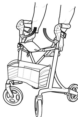
1. Dépliez le déambulateur en appuyant sur les tubes du siège.
