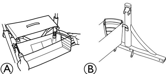
1. Fixez le panier **A** en l'accrochant à la fixation du châssis **B**. Assurez-vous que les crochets sont bien introduits dans la fixation.
