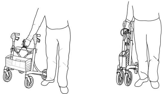
1. Levez la sangle de pliage sur le siège et poussez les poignées de poussée vers l'intérieur pour plier le déambulateur.
