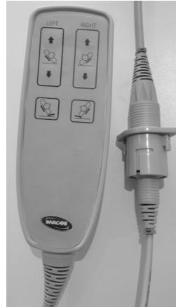
Koble håndkontrollen til kabelen ⑪ og koble strømkabelen ⑩ til strømnettet. Håndkontrollkabelen er markert ⑫ på kabelklemmen som tilsvarer ⑫ på kontrollbokskabelen.
