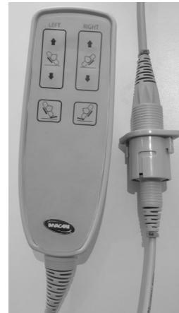
Anslut manöverdosan till kabeln **R** och anslut elsladdens kontakt **Q** till väggeluttaget. Manöverdosans sladd är märkt med **③** på kabelklämmen motsvarande **③** på elektronikboxsladden.
