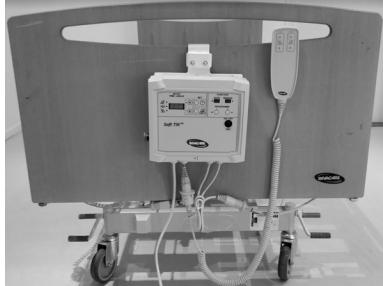
Bind ihop motorsladdarna med ett buntband. Kör sängen uppåt och nedåt för att se till att sladdbunten inte fastnar på några sängdelar och kan röra sig fritt.
