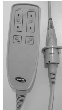
Tilslut håndbetjeningen til kabel ®, og tilslut strømledningen ® til ledningsnettet. Håndkontrolkablet er markeret ③ på kabelklemmen svarende til ③ på kontrolbokskablet.
