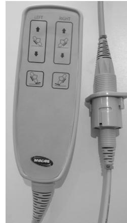
Verbind de handbediening met kabel ⑪ en verbind de voedingskabel ⑩ met de netstroom. De handbedieningskabel is gelabeld ⑬ op de kabelklem die hoort bij ⑭ op de kabel van het bedieningskastje.
