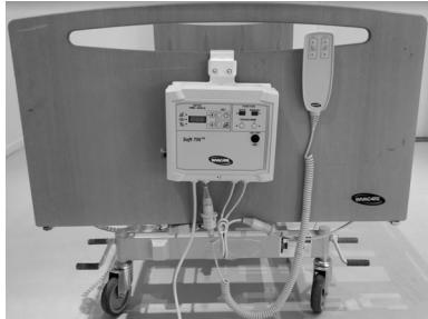
Verzamel de motorkabels in een bundel en maak deze vast met een tie-wrap. Schuif het bed heen en weer om te zorgen dat de bundel niet blijft haken achter bedonderdelen en dat deze vrij kan bewegen.
