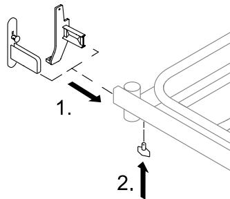
1. Plaats de eindbeugels in de zijbuizen van het matrasbodemplatform.
