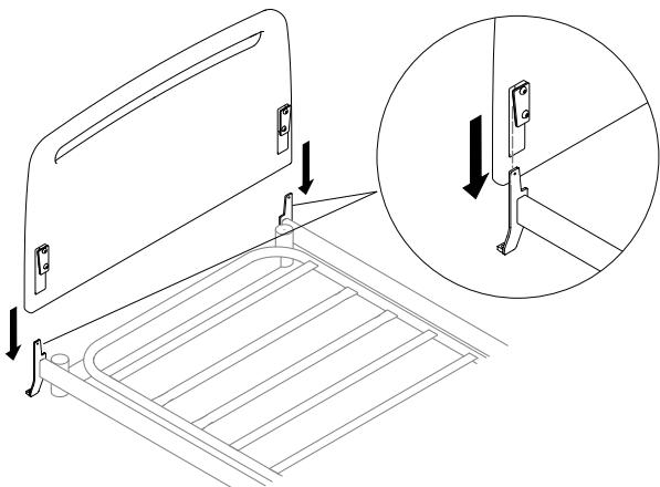
Breng de sleuven op het beduiteinde op één lijn met de houders van de snelmontagebeugels en laat het beduiteinde op de beugels zakken.
