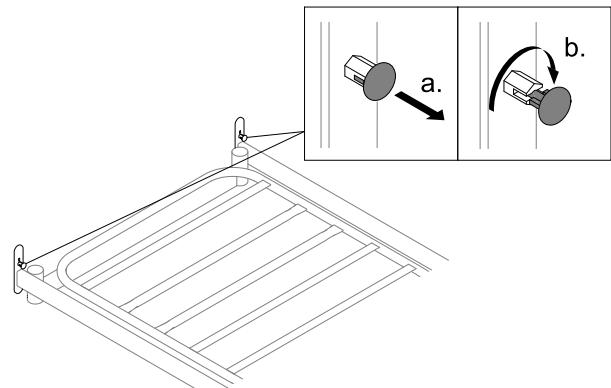
Dra ut låssprinten och rotera den 90 grader för att lossa från sänggaveln på båda sidorna.
