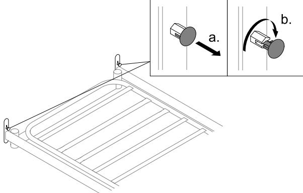
Estrarre il perno di bloccaggio facendolo ruotare di 90 gradi per permettergli di disinnestarsi temporaneamente dal pannello da entrambi i lati.
