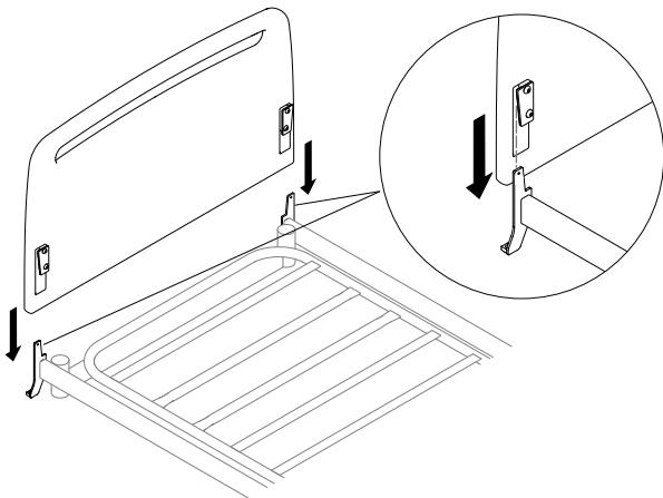
Rett inn sporene på endegavlen etter tappene på hurtigbraketten, og senk endegavlen ned på brakettene.
