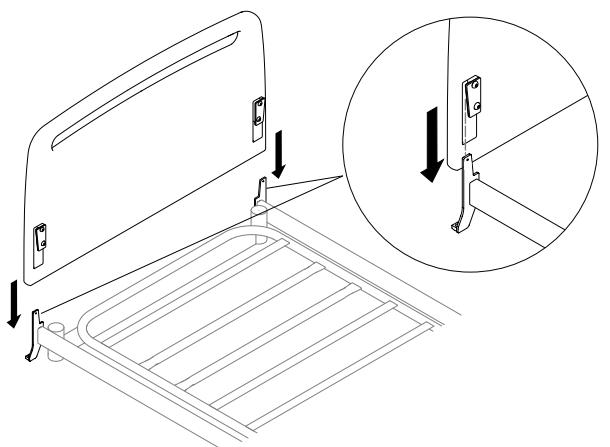
Ret hullerne på gavlen ind efter fligene på lynbeslaget, og sænk gavlen ned på beslagene.
