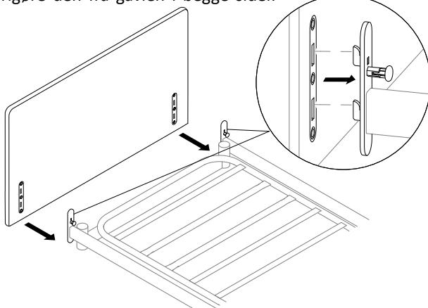
Ret hullerne i gavlen ind efter fligene på Sanne-beslaget, og placer gavlen på fligene.
