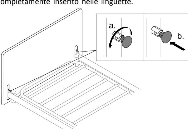
Ruotare il perno di bloccaggio e consentire che si innesti con il pannello su entrambi i lati.
