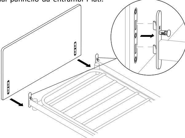
Allineare le fessure sul pannello con le linguette della staffa tipo Sanne e posizionare il pannello sulle linguette.
