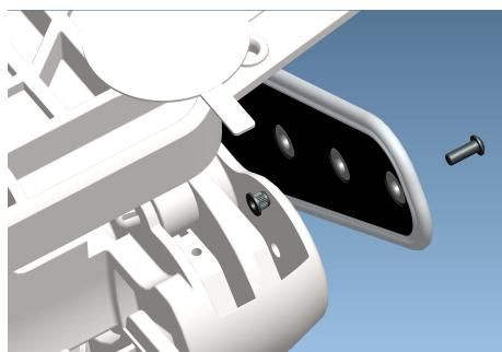
1. Mit Hilfe der Bohrschablone in der Sitzplatte eine Bohrung Ø 8,0 mm durch die äußere Rippe herstellen.
