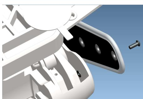
2. Einschlagmutter von innen durch die Bohrung führen und mit der Schraube M6 in die Bohrung ziehen.
