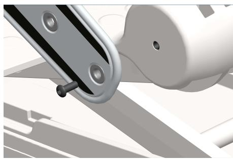
3. Schraube durch die Gurtöse von außen in die Einschlagmutter eindrehen.
