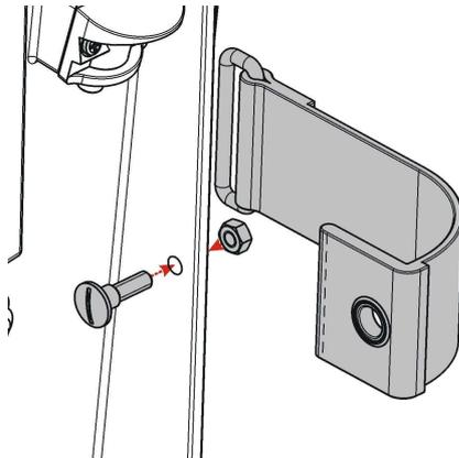
1. Mit Hilfe der Bohrschablone auf der Rückseite eine Bohrung  $\varnothing$  6,5 mm durch die äußere Rippe herstellen.
